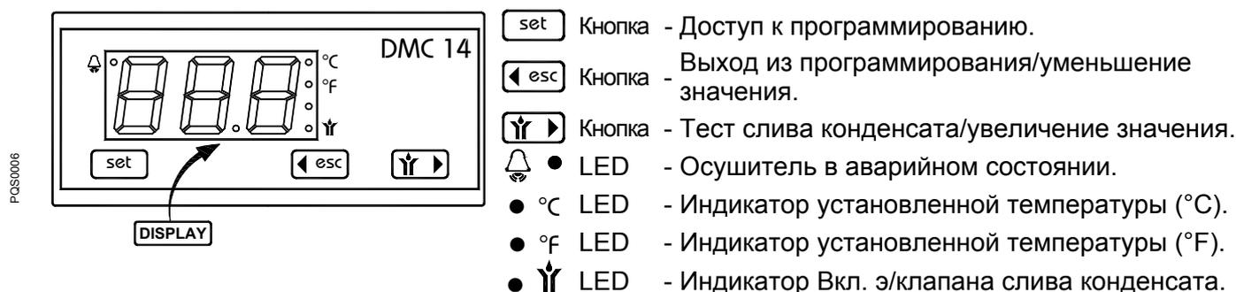
Контроллер DMC14 осуществляет двойную функцию: при помощи цифрового термометра с буквенно-цифровым дисплеем отображается Точка Росы (DewPoint) измеряемая датчиком, расположенным в испарителе; встроенный электронный таймер включает через программируемые интервалы, электроклапан слива конденсата.
