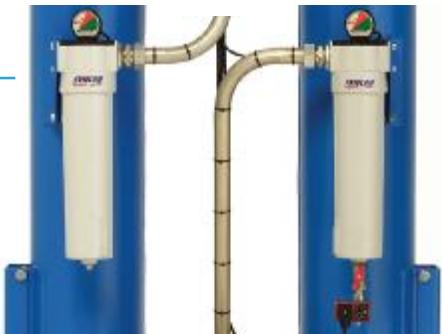
Осушители укомплектованы масло удаляющим фильтром 0,01 микрона на входе (с автоматическим сливом конденсата) и пыле улавливающим фильтром 1 микрон на выходе.
