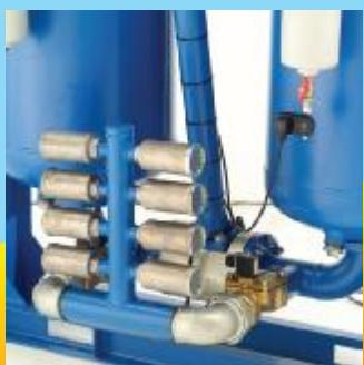
Глушители шума, расположенные с задней части осушителя, легко доступны для демонтажа и замены. Изготовлены из сплава алюминия, гарантируют максимальную защищенность при декомпрессии. Для профилактики достаточно промывки горячей водой с моющим средством.
